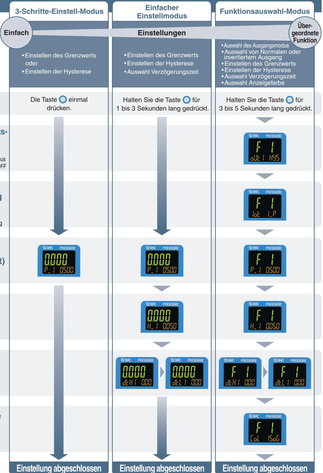
\* Die obige Abbildung zeigt die Funktion von OUT1. Der Funktionsauswahl-Modus für OUT2 wird mit „F2“ ausgewählt. In der obigen Abbildung wird „2“ anstelle von „1“ angezeigt. (Beispiel) P\_1 → P\_2
