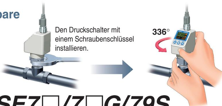
Den Druckschalter mit einem Schraubenschlüssel installieren.
