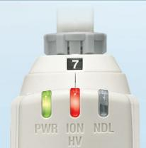
Schaltet sich ein, wenn eine verminderte elektrostatische Neutralisierungsleistung aufgrund von Verunreinigung, Verschleiß oder Bruch der Elektrodennadel festgestellt wird.
