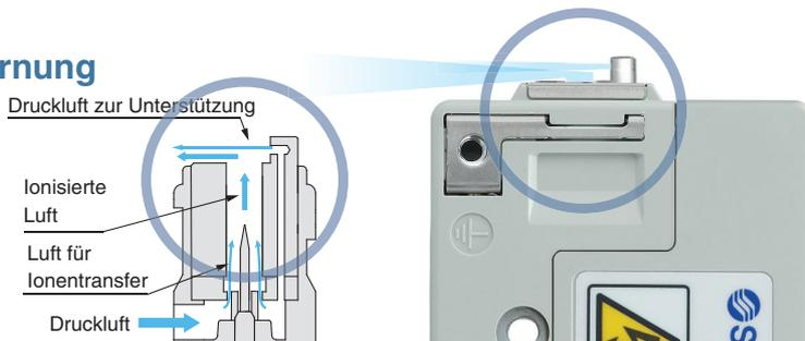
■ Abbau statischer Elektrizität auf engen Förderanlagen
