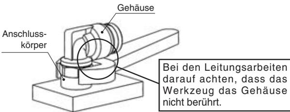
2. **Verbindungskrümmen, Verbindungs-T-Stücke, Y-Stücke, T-Steckverbindungen mit Reduktion sowie Y-Steckverbindungen mit Reduktion müssen durch das Befestigungsloch fixiert werden.**
