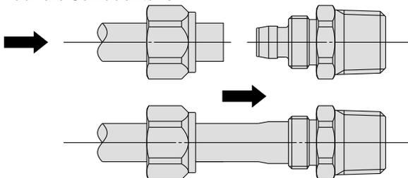
3. Setzen Sie die Überwurfmutter an und ziehen Sie sie vorerst per Hand fest.
