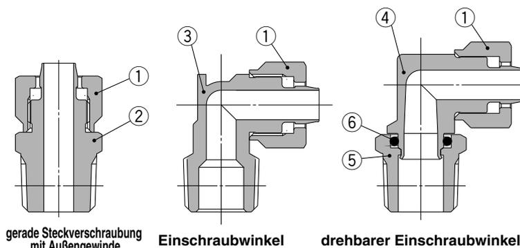
gerade Steckverschraubung mit Außengewinde
