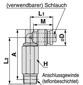
\* Referenzabmessungen nach Einbau des NPT-Gewindes
