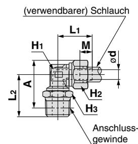
\* Referenzabmessungen nach Einbau des R-Gewindes
