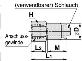
Anm. 1)  $\varnothing D$  ist der max. Durchmesser.
