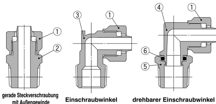
gerade Steckverschraubung mit Außengewinde
